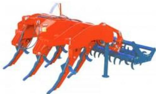
При использовании данной модели глубокорыхлителей возможны интенсивное рыхление глубоких почвенных слоев, измельчение и перемешивание верхнего слоя почвы. За интенсивное рыхление отвечает агрессивное положение лап в грунте.
