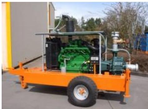
Дизельные центробежные насосы применяются для подачи воды в трубопровод, либо в качестве бустерного насоса, увеличивающего давление для работы дождевальной машины. Для работы на точке водозабора насос оснащен гарнитурой разряжения с гибкой трубой и заборной корзиной с обратным клапаном. Также имеется напорная гарнитура, позволяющая технологично соединить насос с напорным трубопроводом, ведущим к дождевальным машинам.
