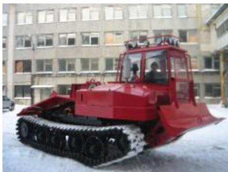
Машина Онежец 320 предназначена для замены машины трелевочной ТЛТ-100А-06. Машина оснащена новой кабиной, усиленной рамой, ходовой системой повышенной проходимости с широкой гусеницей и планетарными бортовыми редукторами с приближенными к опорной поверхности ведущими колесами большего диаметра.
