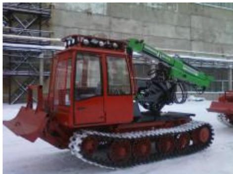
Машина Онежец 330 предназначена для замены машины трелевочной ТБ-1МА-15, оборудована гидроманипулятором СФ-65Л и зажимным коником. Машина предназначена для бесчokerной трелевки леса, используется круглогодично на рубках главного и промежуточного пользования, преимущественно на лесосеках с пересеченным рельефом, дренированных грунтах, грунтах с низкой несущей способностью и при глубокой снежной целине.
