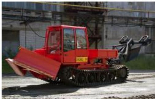
Машина лесохозяйственная гусеничная Онежец 380 с комплектом дополнительного оборудования – универсальная лесная машина, предназначенная для выполнения любых лесохозяйственных работ, в том числе и для борьбы с лесными пожарами путем прокладки противопожарных полос (борозд).
