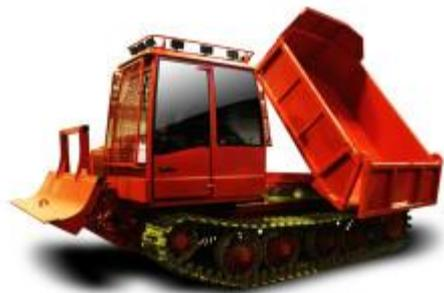
Трактор с самосвальным кузовом Онежец 392 предназначен для перевозки сыпучих грузов (песка, щебня, торфа и т.д). Оснащение трактора ходовой системой повышенной проходимости с более широкой гусеницей и двухступенчатыми бортовыми редукторами с приближенными к опорной поверхности ведущими колесами большого диаметра позволяет использовать его на грунтах с низкой несущей способностью, в том числе на переувлажненных почвах и на болотах.
