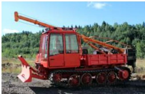
Бурильно-крановая машина Онежec 395 предназначена для бурения котлованов в грунтах 1-4 категорий и установки опор при строительстве и ремонте линий электропередач, а также на линиях связи. По основным базовым узлам: дизель, кабина, трансмиссия, движитель машина соответствует трактору Онежec 300 БС. На крыше кабины установлены дополнительные фары освещения рабочей зоны с ограждением.
