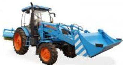
АГРОМАШ предлагает широкий модельный ряд погрузочно-уборочных машин на базе тракторов АГРОМАШ 30ТК, АГРОМАШ 50ТК, АГРОМАШ 60ТК. Грузочно-уборочные машины предназначены для уборки снега и мусора с улиц, площадей, дорог и тротуаров, для планировки насыпного грунта и засыпки им траншей и ям, для выполнения уборочных и земляных работ на грунтах I и II категории.
