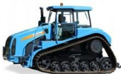
Предназначен для выполнения комплекса сельскохозяйственных работ по основной и предпосевной обработке почвы, в том числе пахоты средних и тяжелых почв на глубину до 40см, двух-трех ярусной вспашки, глубокого безотвального рыхления, плантажной вспашки, сплошной культивации, сева зерновых, проведения уборочных и транспортных работ, лущения стерни и дискования почв, внесения удобрений, снегозадержания, закрытия влаги и других работ на равнинах и склонах крутизной до 10 градусов.
